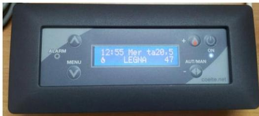
La centralina con aggiornamento 2015 offre la possibilità di collegare un pannello remoto per consentire di eseguire alcune operazioni da una postazione diversa da quella in cui è situata la caldaia.
