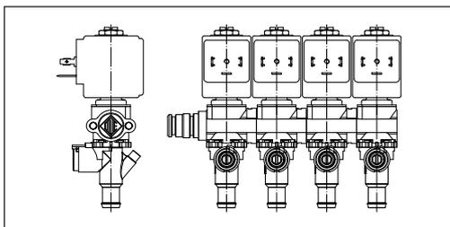
I gruppetti di elettrovalvole a caduta, dal punto di vista funzionale sono identici alle elettrovalvole a caduta singole. L'unica differenza è che possono essere accoppiate in modo tale da formare un gruppo di elettrovalvole che presenta un raccordo di alimentazione e diversi utilizzi ognuno dei quali può essere aperto alimentando la bobina corrispondente.
