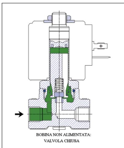
Le elettrovalvole a 2 vie normalmente chiuse a comando diretto presentano un raccordo di entrata ed un raccordo di utilizzo. Il nucleo mobile, sul quale è montata una guarnizione di tenuta, provvede direttamente ad aprire e a chiudere l'orificio principale dell'elettrovalvola. Quando la bobina non è alimentata, il nucleo mobile si trova in posizione tale da chiudere l'orificio non permettendo il passaggio del fluido.
