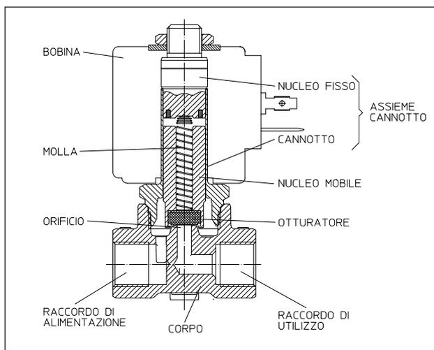
**Nucleo fisso:** componente in materiale ferromagnetico che grazie all'effetto di un campo magnetico, generato dalla bobina, attira verso di sé il nucleo mobile.
