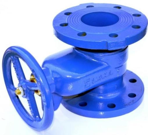
**Saracinesca di presidio** che combina le caratteristiche delle saracinesche a quelle delle valvole. Unisce bassa perdita di carico, passaggio libero, chiusura e apertura graduale a modulazione continua e tenuta con liquidi abrasivi, calcarei o con parti in sospensione.
