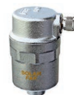
Fig.1 En absence d'air dans le circuit, l'eau qui se trouve dans la vanne maintient le flotteur dans la position de fermeture du clapet.
