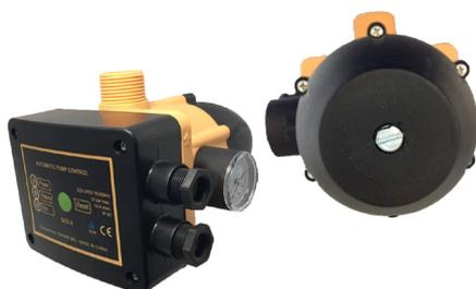
Regolatore di pressione automatico degli impianti di pressurizzazione idrica. Avviamento e spegnimento automatico della pompa a chiusura dei rubinetti. Protegge l'impianto contro il funzionamento a secco quando la pompa supera la capacità di aspirazione. Tensione di alimentazione 230V 50Hz. Protezione IP65. Pressione max di esercizio 10 Bar. Temperatura max di esercizio 60° C. Attacchi 1" maschio/maschio. Corpo in nylon. Membrana in NBR. Flussostato in ottone.
