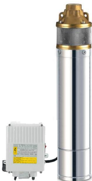
Elettropompa sommersa monoblocco periferica. Realizzata per il sollevamento di acque pulite da pozzo o vasca, trova applicazioni sia nella irrigazione di orti e giardini che per la pressurizzazione domestica. Corpo pompa in ottone, girante in ottone, camicia in acciaio inossidabile AISI 304, albero motore AISI 420, doppia tenuta meccanica alumina-carbone-grafite. Alimentazione con 20 metri di cavo. Uscita filettata 1".
