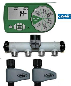
Due elettrovalvole sono già incorporate. E' possibile acquistare a parte fino ad altre due elettrovalvole in modo tale da poter gestire autonomamente fino a 4 settori. Attacco rubinetto da 3/4" filettato Femmina, quattro uscite da 3/4" filettate Maschio.
