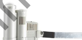
Il sensore Solar Sync ET è un sensore meteo avanzato che calcola l'evapotraspirazione (ET) e regola giornalmente i programmatori Hunter in base alle condizioni meteorologiche locali. Solar Sync misura la luce del sole e la temperatura e utilizza l'ET per determinare la percentuale di regolazione stagionale corretta da inviare al programmatore.
